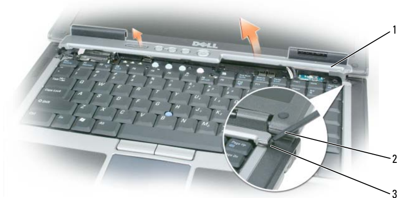
1 шарнирная крышка 2 пластмассовая палочка 3 щель
